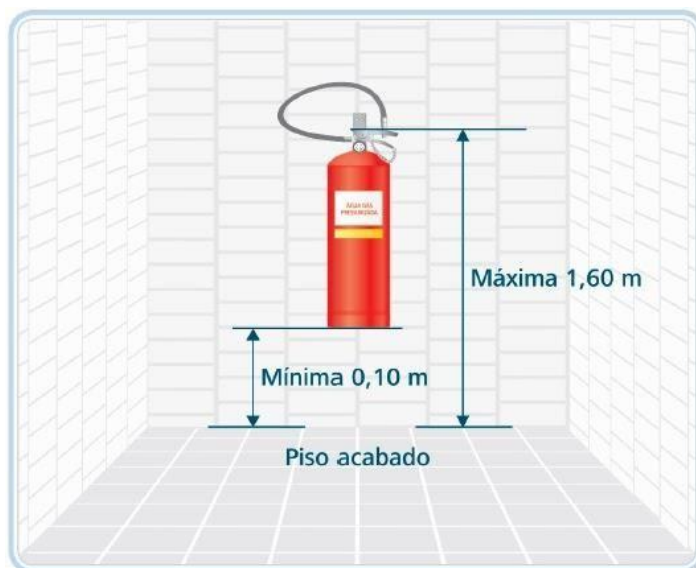
Figura 25 - Fixação extintor de incêndio
